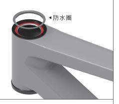
04 上蓋依照要穿過的線徑種類,安裝合適的防水塞。
